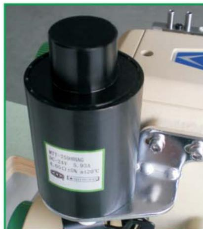
率先專利開發，電磁直驅式抬壓腳組，不產生雜音，反應更為靈敏。
