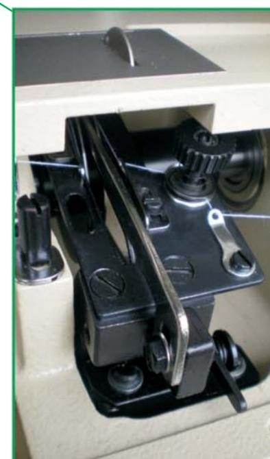
穿底線時只需輕輕按動按鈕，底線底座便會從機器內部彈出，即可簡單的進行穿線，進一步提高操作者的工作效率。
