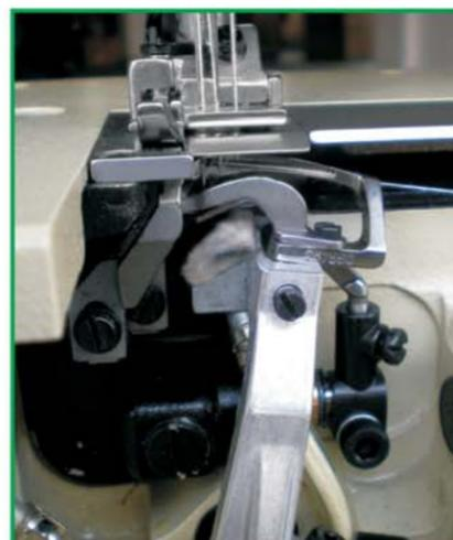
採用移動式護針器，可保護機針減少磨損，防止跳線，保持穩定美觀的針腳。
